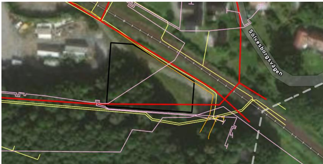
Figur 8. Övriga ledningar inom och kring planområdet. Rosa ledningar tillhör Olofström kraft, gula och orangea tillhör Skanova respektive Tele2, och röda ledningar är spillvattenledningar tillhörande BEVAB. Även vattenledningar tillhörande BEVAB finns i anslutning till planområdet, men illustreras inte i bild.
