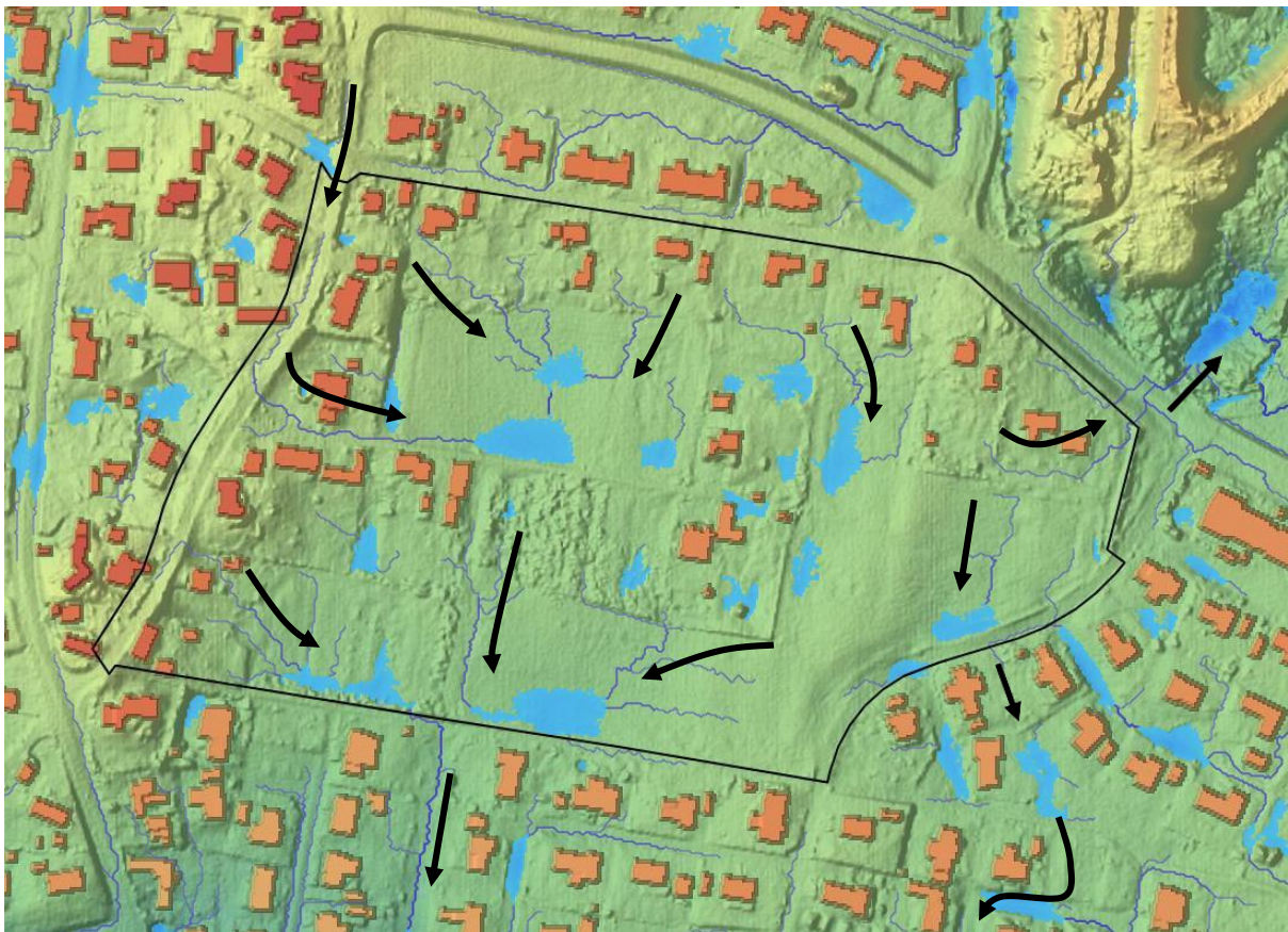
Bild 3. Utredningsområdets topografi och nuvarande avrinningsvägar. Blå linjer visar rinnvägar, svarta pilar avrinningsriktning, och blå ytor visar instängda områden där avrinning ansamlas. Plangräns markeras med svart linje. (Scalco Live, 2021).
