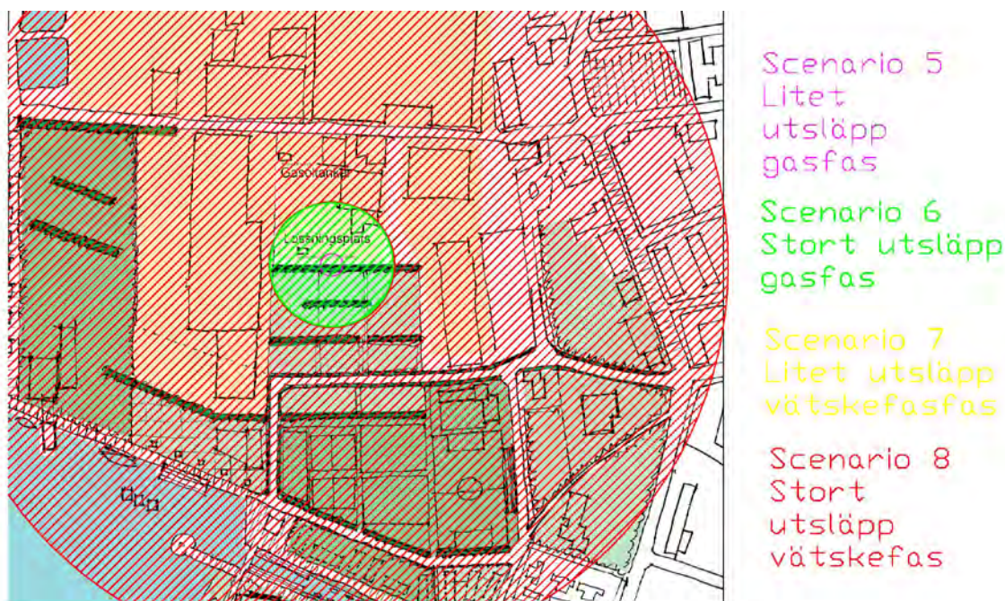
Figur 5. Skadeområde vid antändning av gasmoln vid olika utsläppscenarier vid lossningsplatsen.
