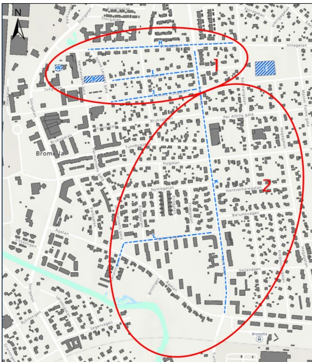
Figur 13. Åtgärdsförslag för centrala Bromölla med två prioriterade områden markerade i rött. Blå ytor illustrerar prioriterade översvämningsytor och markeras A-C. Blå linjer illustrerar prioriterade rinnvägar och markeras H-L (Tyréns, 2020).
