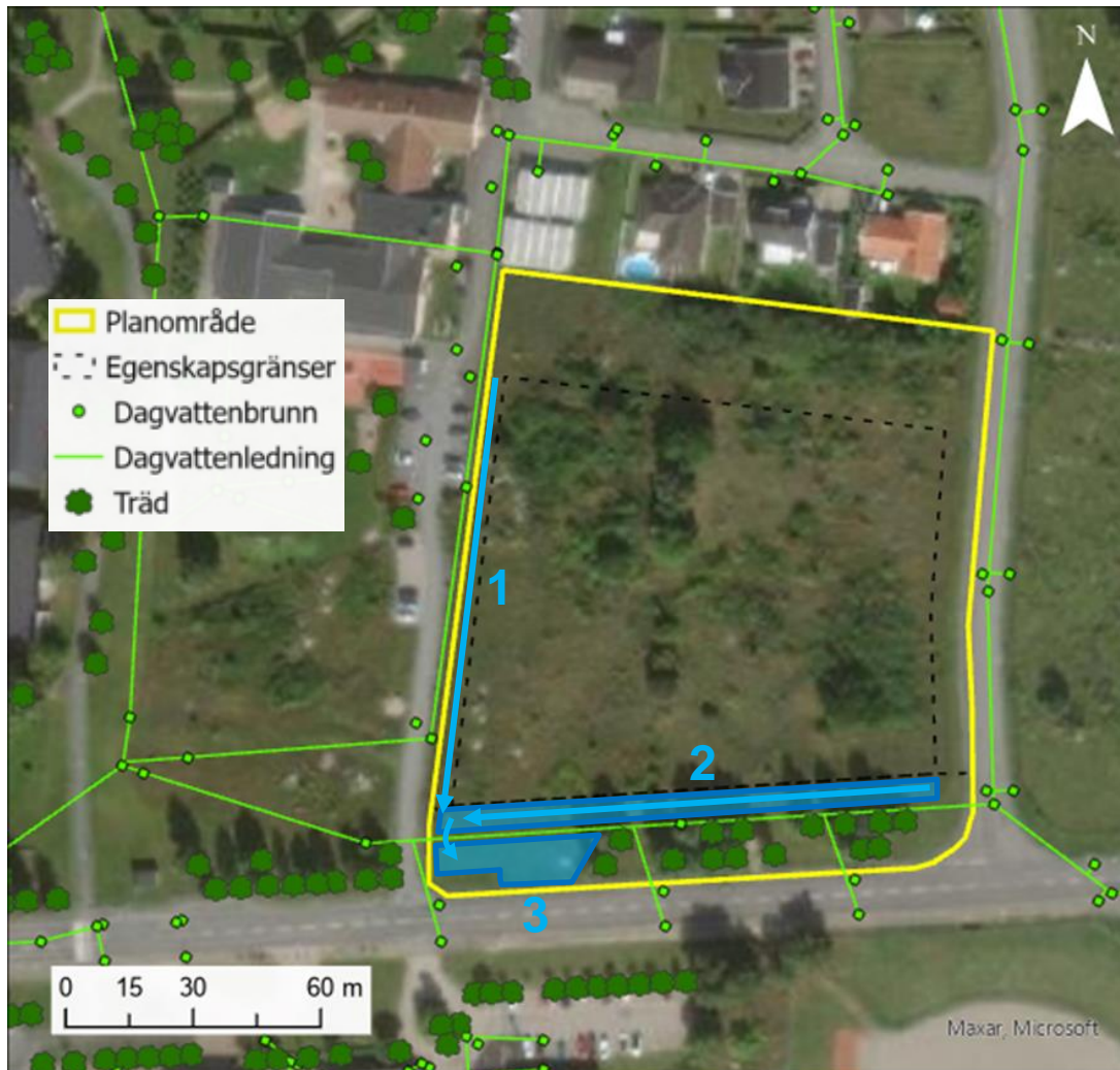
Figur 14. Karta som visar föreslagen dagvattenhantering i form av svackdiken (1 och 2) och torrdamm (3). Både det södra av svackdikena (2) och torrdammen (3) föreslås utformas för fördörjning av dagvatten.
