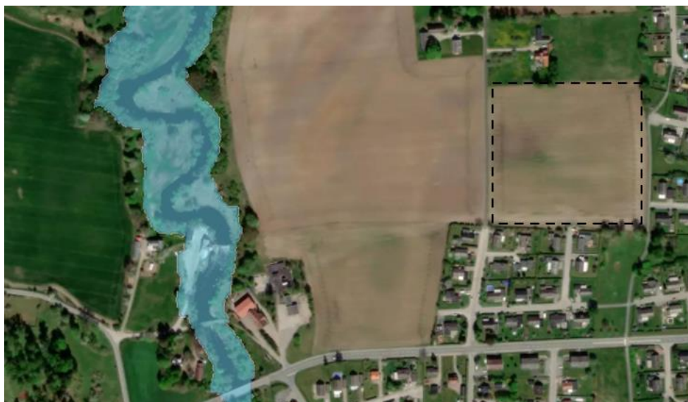
Figur 8. I blått ses Holjeån vattennivå vid 100-årsflöde enligt MSB:s översvämningskartering. Planområdet visas med svart streckad linje.
