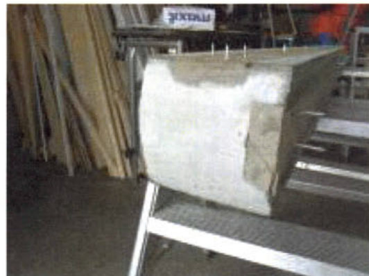
Detalj. Notera avrundningen på stolptoppen.
