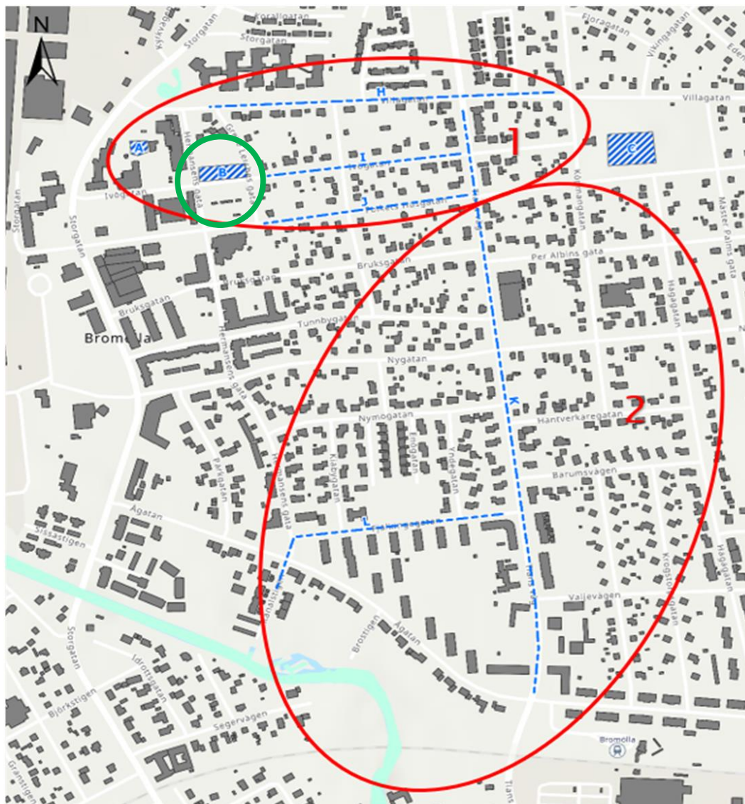
Figur 7. Åtgärdsförslag för centrala Bromölla med två prioriterade områden markerade i rött. Blå ytor illustrerar prioriterade översvämningssytor och markeras A-C. Blå linjer illustrerar prioriterade rinnvägar och markeras H-L (Tyréns, 2020). Planområdet markerat i grönt.
