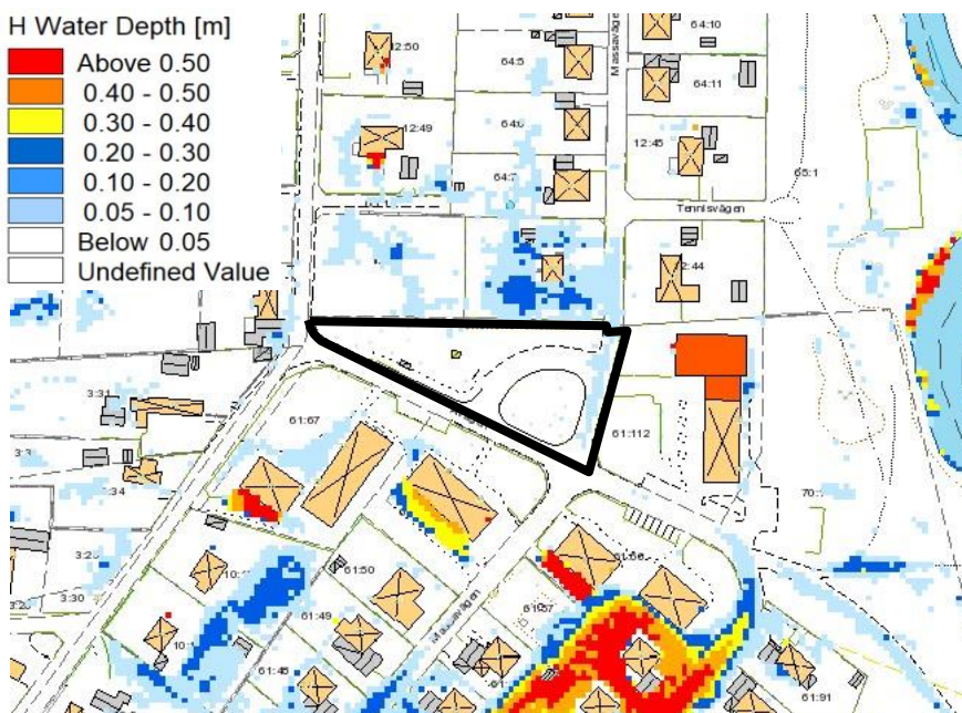
Figur 5. Maximala översvämningar vid ett simulerat 100-årsregn enligt skyfallskartering över Nymölla. Ungefärligt planområde markerat med svart linje.
